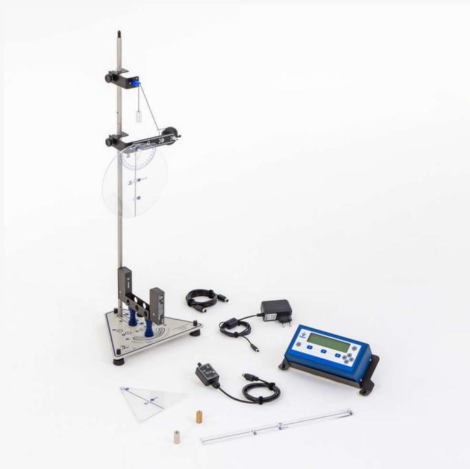
Conjunto de péndulo simple y péndulos físicos, rodamiento, torres magnéticas, multímetro y sensor.
