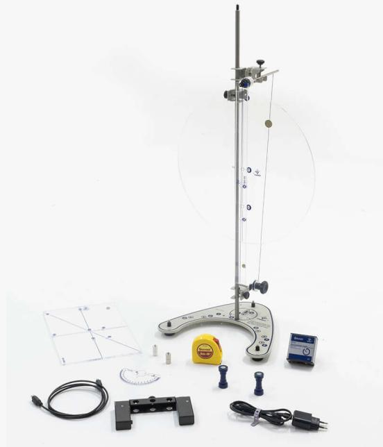
Conjunto de pêndulo simples e pêndulos físicos, pivô rolamentado, com multicronômetro Bluetooth
