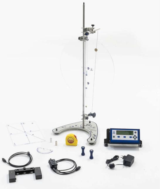
Conjunto pêndulo simples e pêndulos físicos, pivô rolamentado, com multimedidor
