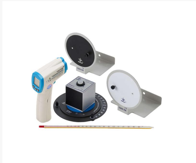
Conjunto radiação térmica, cubo de Leslie, placas circulares, com termômetros de coluna e infravermelho
